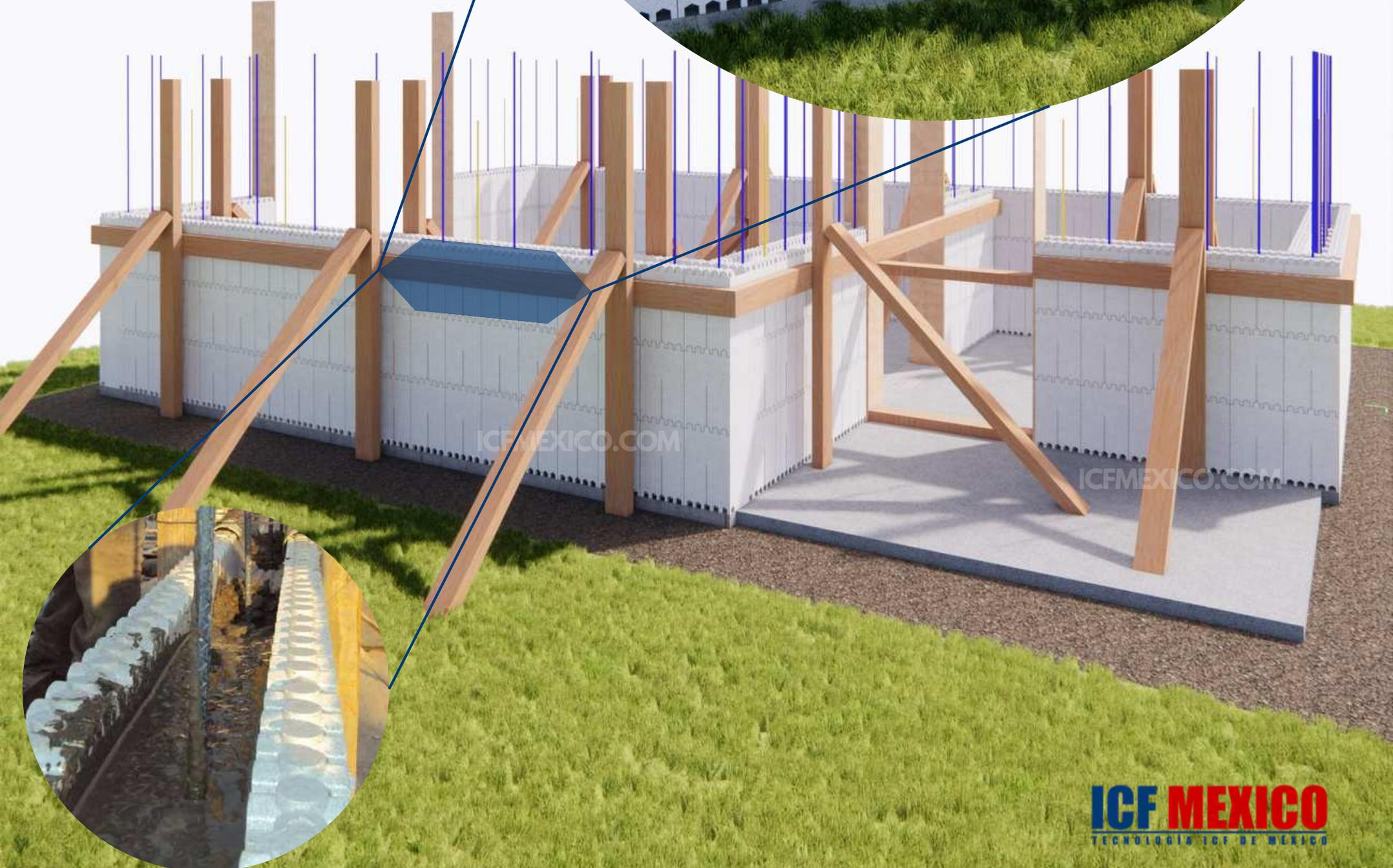
Para ventanas y puertas pequeñas con un largo no mayor a 2m se colocaran varillas del #4 (1/2) en la parte interior de los ICF como refuerzo para los vanos de puertas y ventanas, se colocara una varilla en la parte inferior de la ventana y en la parte superior se colocaran varillas del mismo numero (4) a cada 30cm hasta llegar a la altura de la losa desea.
