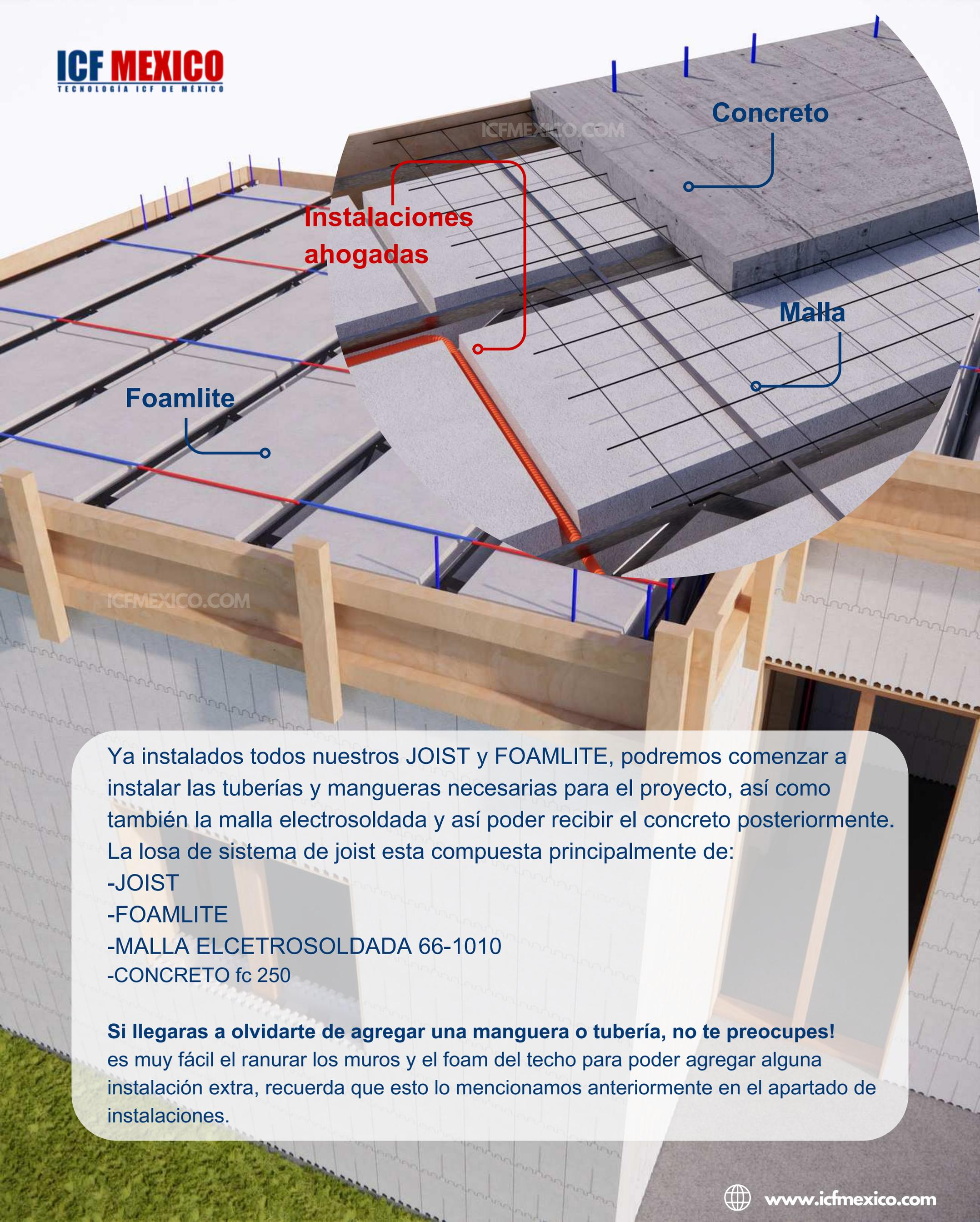
Ya instalados todos nuestros JOIST y FOAMLITE, podremos comenzar a instalar las tuberías y mangueras necesarias para el proyecto, así como también la malla electrosoldada y así poder recibir el concreto posteriormente. La losa de sistema de joist esta compuesta principalmente de:
